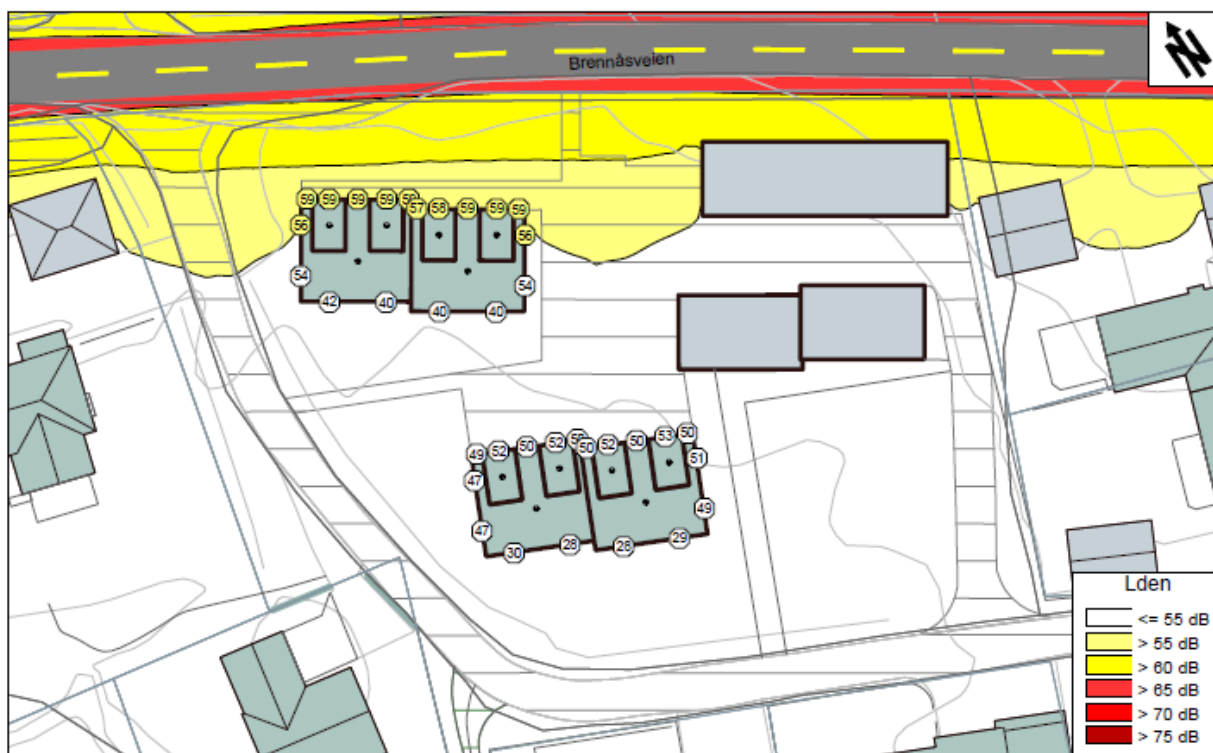
Figur 3 Utklipp fra vedlegg X001 som viser beregnet ekvivalent støynivå fra veitrafikk, L_{den} , i 1,5 m høyde over uteoppholdsareal på terreng og høyeste beregnede støynivå ved fasade vist i de små sirkelene/heksagonene rundt byggene.
