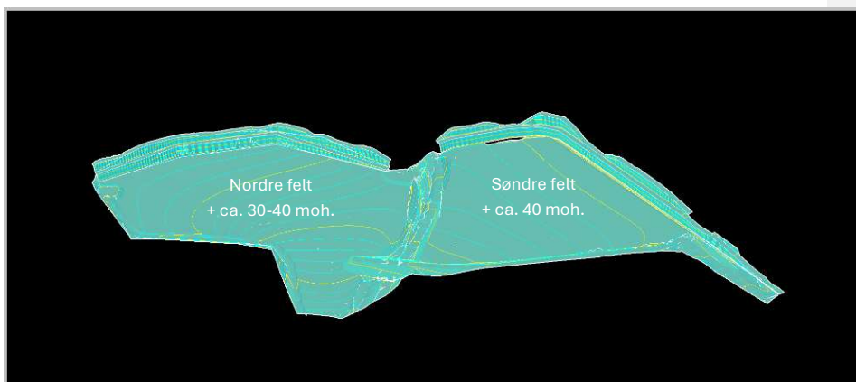
Figur 5-4: Utsnitt fra terrengmodell som viser mulig utforming av terrenget. Fjellskjæringer i bakgrunnen. Feltene heller mot nord og vest.
