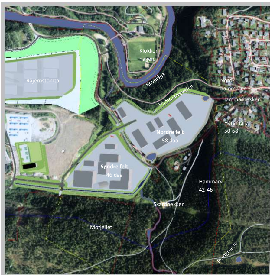
Figur 5-1: Foreløpig illustrasjonsplan (fra modell). Plangrense er vist med gul, stiplet linje. Nye industriarealer søndre og nordre felt er vist med lys grå flater. Skjæringer og fyllinger er vist med grå og grønt. Bekker med blått.
