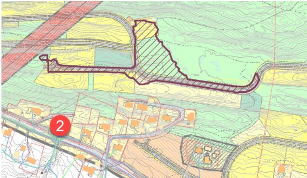
Figur 18 - Ny nedbørsfelt for tilkoblingspunkt 2
