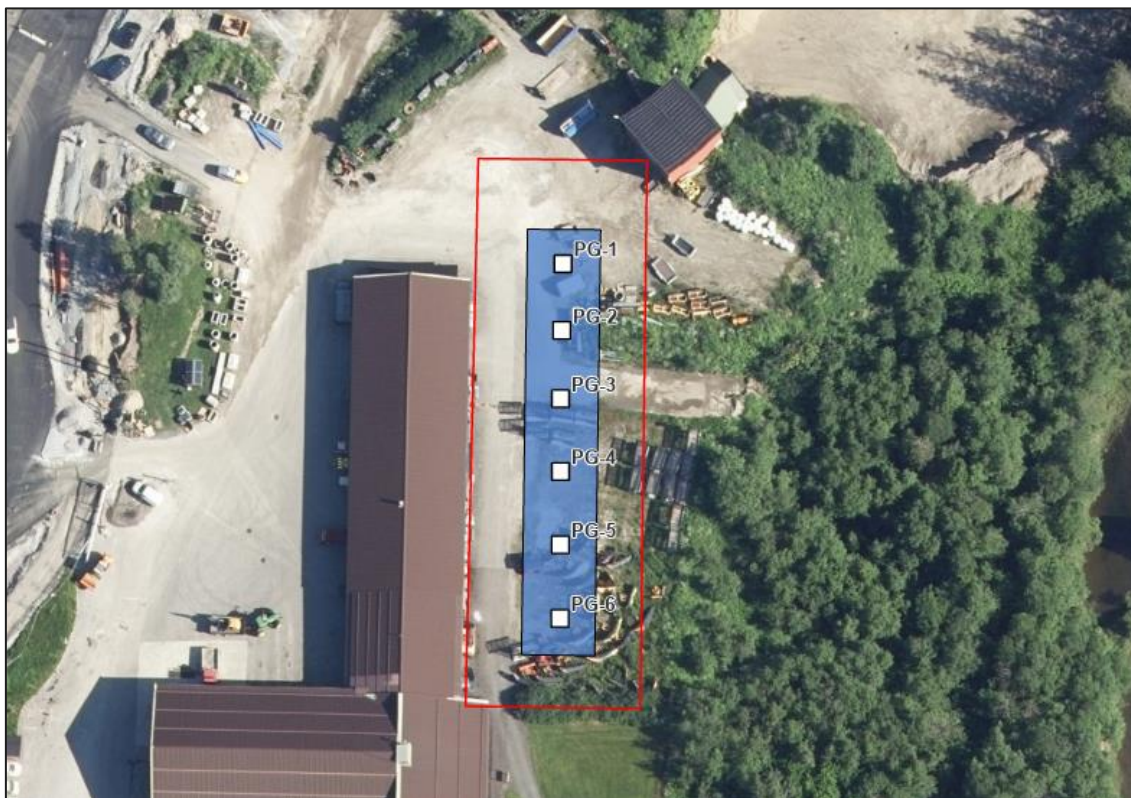
Figur 3 Prøveplan for den miljøgeologiske undersøkelsen. Prosjektområdet er markert med rødt omriss, carportens fotavtrykk er markert med blå skravur, mens prøvepunktene er merket med hvite firkanter.
