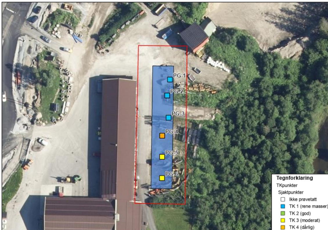
Figur 8 Situasjonsplan som viser prøvepunktene farget med høyeste påviste tilstandsklasse for forurenset grunn jf. Miljødirektoratets digitale veileder.
