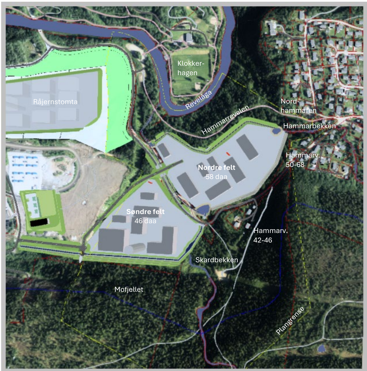
Figur 4-1: Foreløpig illustrasjonsplan (fra modell). Plangrense er vist med gul, stiplet linje. Nye industriarealer søndre og nordre felt er vist med lys grå flater. Skjæringer og fyllinger er vist med grå og grønt. Bekker med blått.
