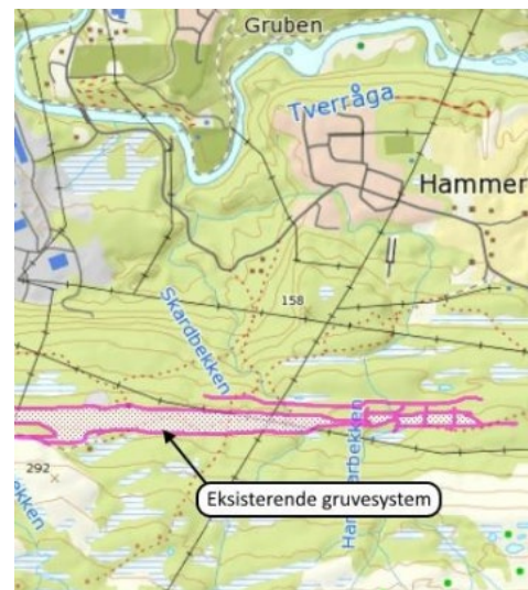
Figur 4-9: Eksisterende gruvesystem (rosa markering).
