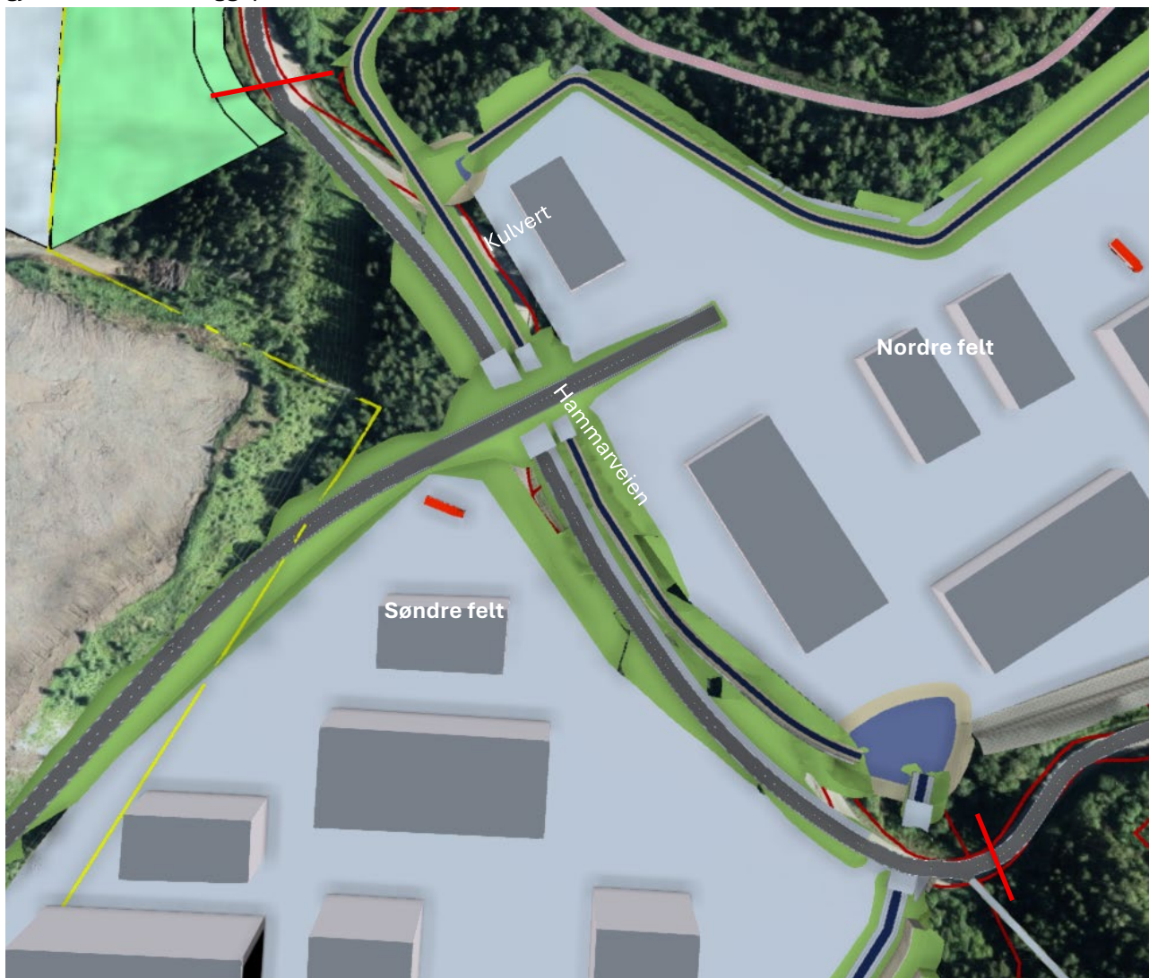
Figur 4-2: Hammarveien legges om og utbedres ved nytt industriområde på strekning mellom røde linjer på bildet (utsnitt fra modell).
