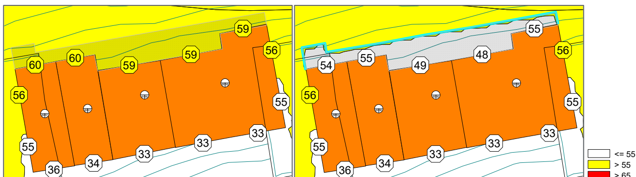
Figur 6: Venstre: Støynivå på svalgang/balkong uten tett rekkverk. Høyre: Støynivå på svalgang/balkong med tett rekkverk. Eksempelet her viser 3.et for bygg 1B, men det er tilsvarende resultater for de andre etasjene og byggene mot nord. Støynivåer L_{den} dB er beregnet 1,5 m over svalgang-/balkonggulv.
