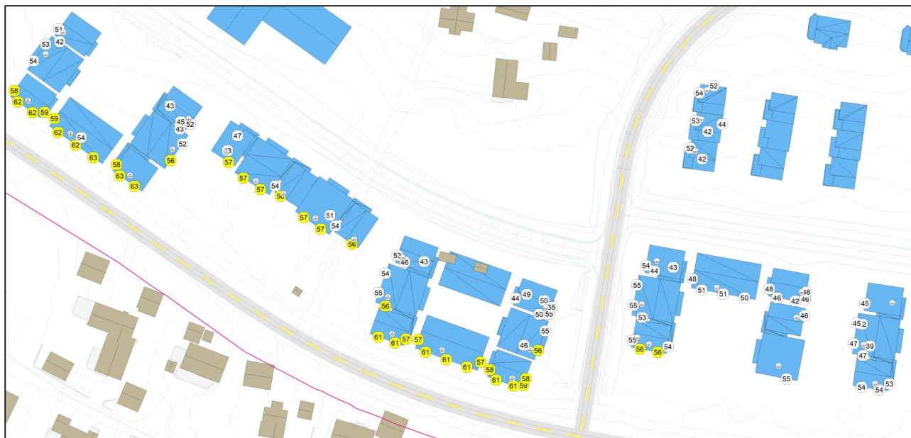
Figur 2: Høyeste beregnede lydnivå, L_{den} , på fasader til de foreslått plassering av nye bygninger nærmest Brennåsveien. Nivåene angir stort sett lydnivå i 2. etasje. Gule tall angir lydnivå over anbefalt grenseverdi på L_{den} = 55 dB.
