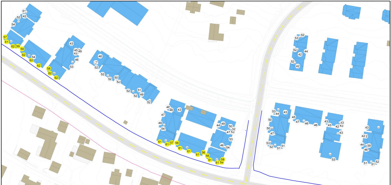
Figur 3: Høyeste beregnede lydnivå, L_{den} , på fasader til de foreslått plassering av nye bygninger nærmest Brennåsenveien. Med foreslått støyskjerming (blå streker). Nivåene angir stort sett lydnivå i 2. etasje.
