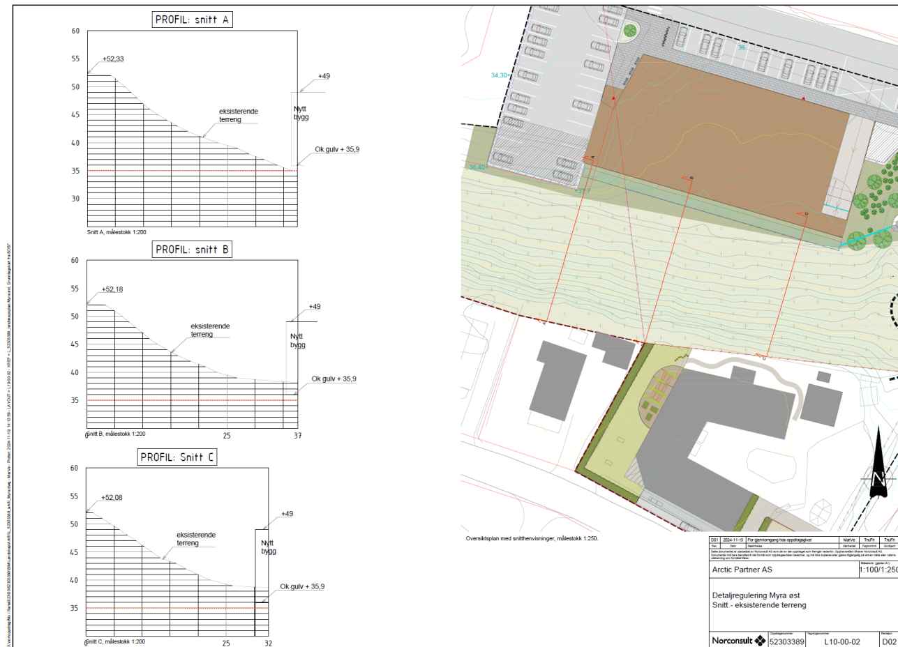
Figur 41 Terrengsnitt fra toppen av skråninga ned til næringstomta med ny bebyggelse vist Kilde: Norconsult
