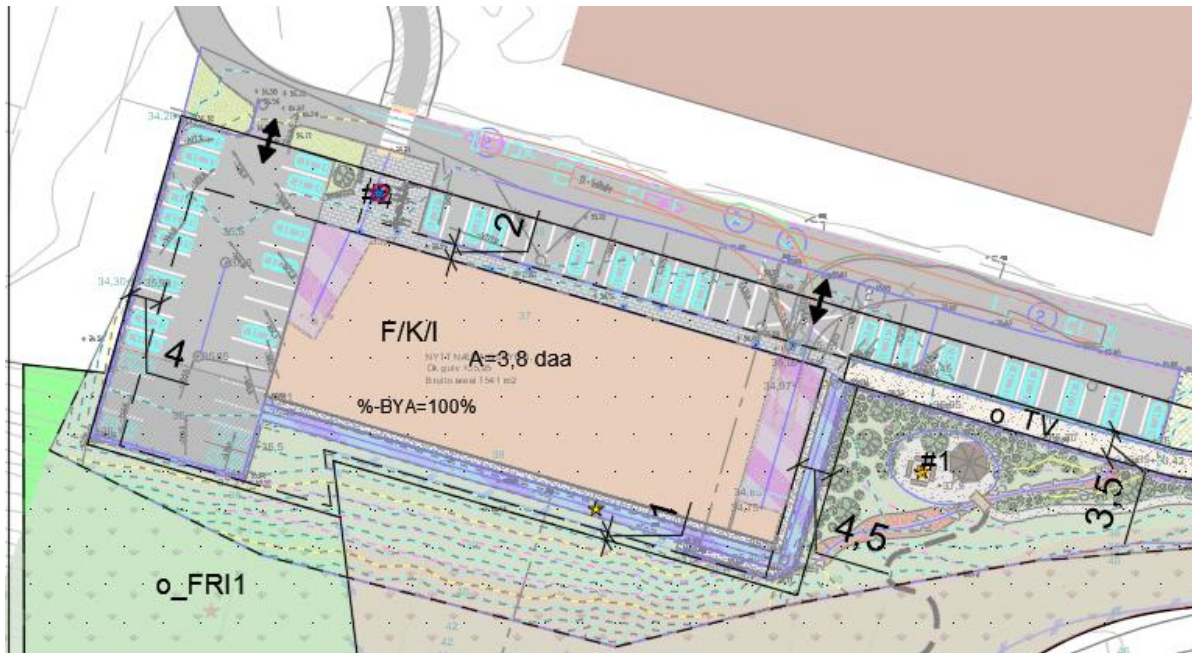
Figur 45 Sporingskurver ved vareleveranse med semitrailere Kilde: Norconsult
