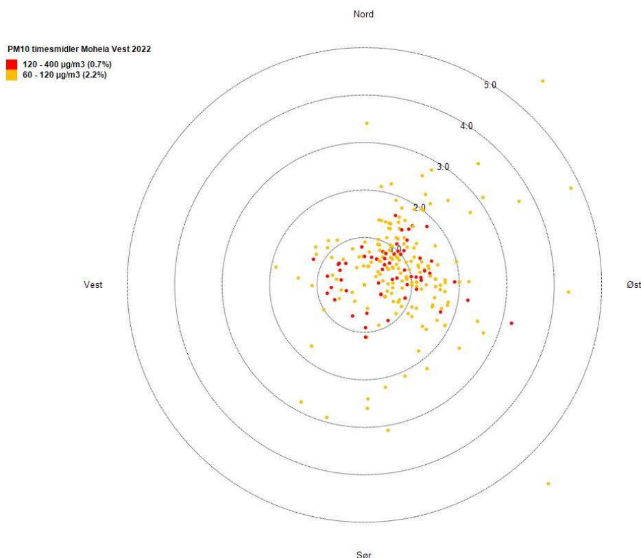
Figur 3-27 Plottet viser vindstyrke og vindretning ved timesmidler svevestøv PM_{10} over 60 \mu\text{g}/\text{m}^3 , målestasjon Moheia Vest 2022. Hver prikk representerer et timesmiddel. Vindstyrken er angitt med sirklene i m/s (innerste sirkel angir 5 m/s).
