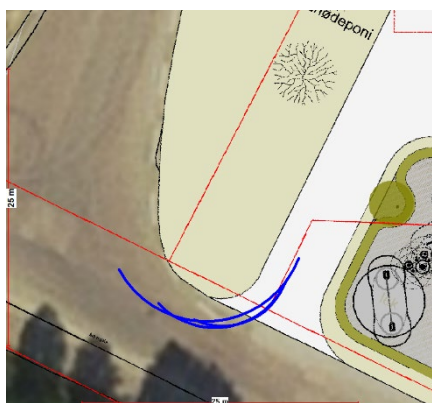
Figur 3. Skisse som viser sporingskurver med radius 6, 7 og 9m
