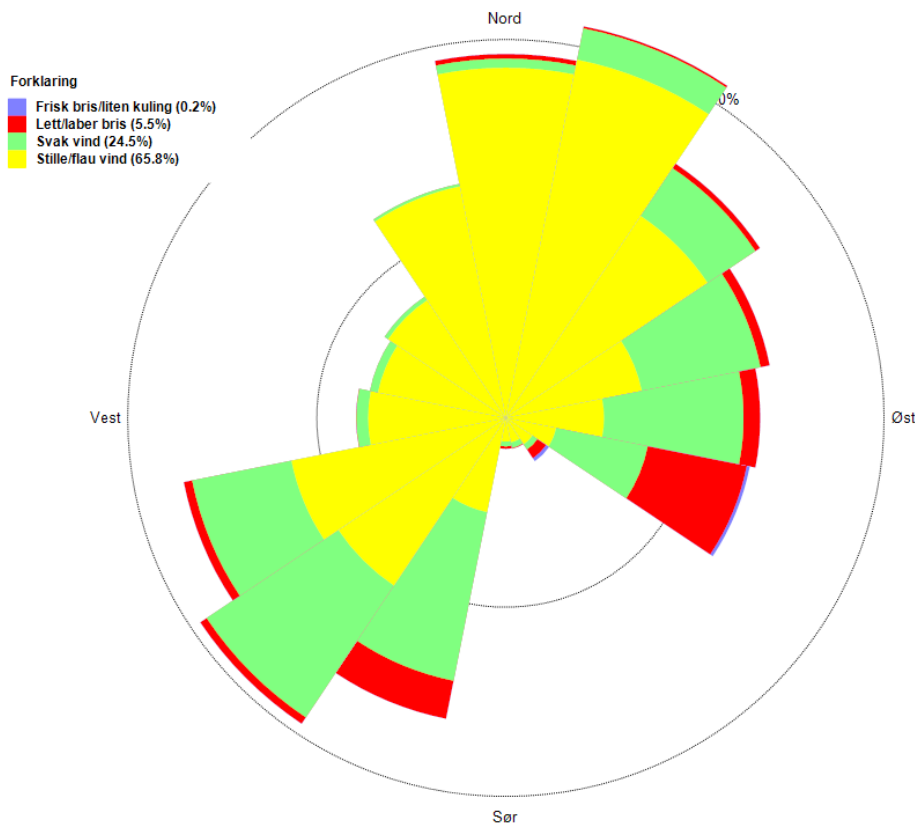
Figur 4-24 Vindrose som viser prosentvis fordeling av vindretninger og vindstyrke (se fargemerking) ved målestasjon Moheia Vest, Mo i Rana 2020. Ytterste ring markerer 10 % andel av timene for året.
