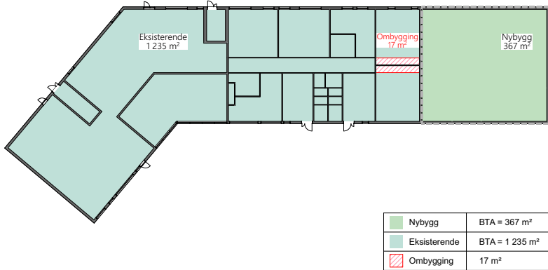
Eksisterende, tilbygg og ombygging
