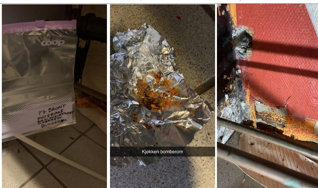
Bilde B38: P10 Vinylbelegg på vegg. Plan U Bomberom kjøkken.
