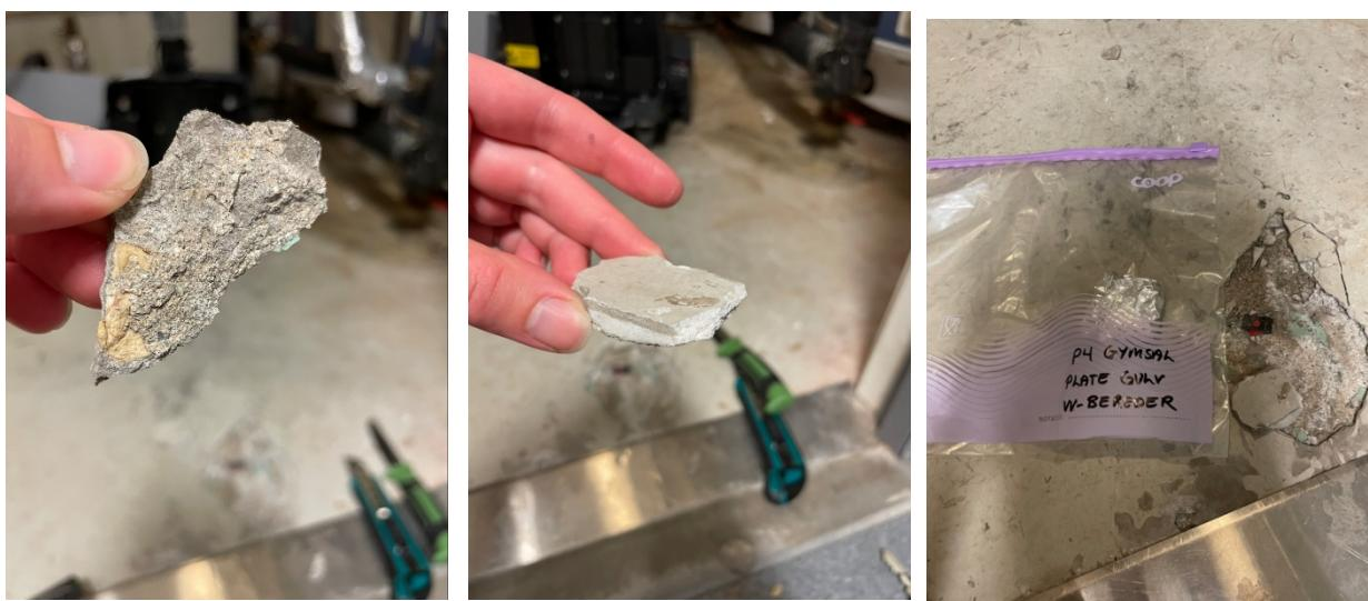
Bilde B34: P4a Grønn maling på betong. Plan U VV-berederrom.
